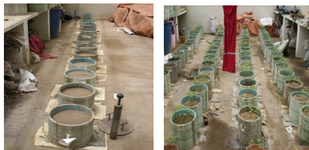
Figura 2. Cilindros, martillo Proctor, soporte de golpes y medidores de humedad utilizados en el estudio.
